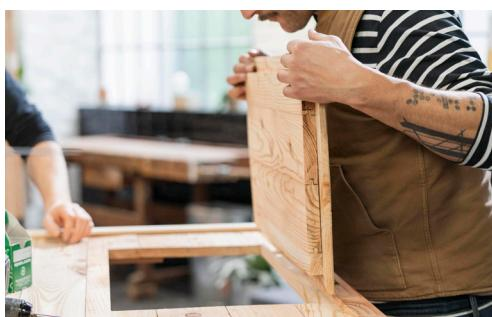
Du willst Griffe an deinen Seitenwänden haben? Dann brauchst du dir pro Griff jetzt nur noch zwei Klötze als Abstandhalter und ein längeres Stück für den Griff zu sägen. Verbinde beide Elemente mit einer Schraube durch jeden Holzklotz. Damit du den Griff auch an einem Stück an der Wand montieren kannst, bohrst du mit einem langen Bohrer durch Griff, Abstandshalter und Wand und verbindest sie durch eine lange Schlossschraube. Von unten konterst du mit einem Sechskant und ziehst die Mutter fest.
