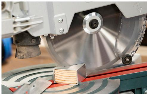
Um den Rahmen zu fertigen, verbindest du immer jeweils zwei Aluprofile mithilfe eines kurzen Vierkantholzes, das an beiden Enden mit Schrauben fixiert wird. Dafür startest du mit dem Anzeichnen des Schraubbildes und bohrst die entsprechenden Löcher vor. Bereite die Löcher danach mit dem Senker vor, stecke die beiden Aluprofile mithilfe des Vierkantholzes zusammen und Schraube die am Holz fest. Mit dieser Technik kannst du den Rahmen individuell in Länge und Breite deinem Haus anpassen.
