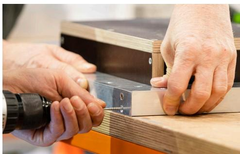
Die Ecken verbindest du mithilfe eines Gehrungsschnittes, sodass der Holzkern vollständig durch das Aluminium verdeckt wird. Dazu setzt du an je ein Ende eines Aluprofils ein Vierkantholz ein und verschraubst es, damit es nicht verrutscht. Anschließend schneidest du die Aluprofile mithilfe der Kapp- und Gehrungssäge im 45°-Winkel zu. Trage Leim auf die Schnittkanten der Hölzer auf, setze die Profile zusammen und verschraube sie. Vergiss auch hier das Vorbohren nicht.
