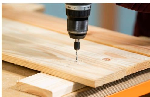
Vor dem Befestigen der Verbindungshölzer zeichnest du auf ihnen ein, wo verschraubt werden soll. Stelle dafür mit einem Streichmaß den passenden Abstand ein, damit du nicht in die Fuge zwischen den beiden Leisten schraubst, und zeichne auf jedem der Verbindungshölzer deine Bohrlöcher ein. Bohre mit einem Senker anschließend vor, damit die Schraube später im Holz verschwindet. Bereite auf diese Weise alle Bretter vor – montiert werden sie erst später, sobald das Gewächshaus im Garten steht.
