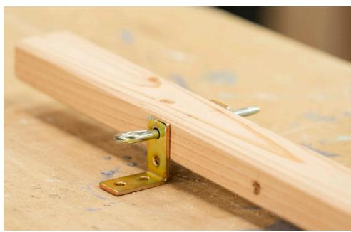
Damit du das Fenster in verschiedenen Stufen öffnen und feststellen kannst, benötigst du zwei Metallwinkel und einen Bolzen. Die beiden Winkel bilden links und rechts vom Griff eine Führung. Damit der Bolzen hindurchpasst, musst du allerdings zunächst jeweils eines der Löcher der Winkel mit dem Standbohrer aufbohren. Bohre im nächsten Schritt mehrere Löcher in gleichmäßigen Abständen in den Griff, um verschiedene Öffnungsstufen zu schaffen.
