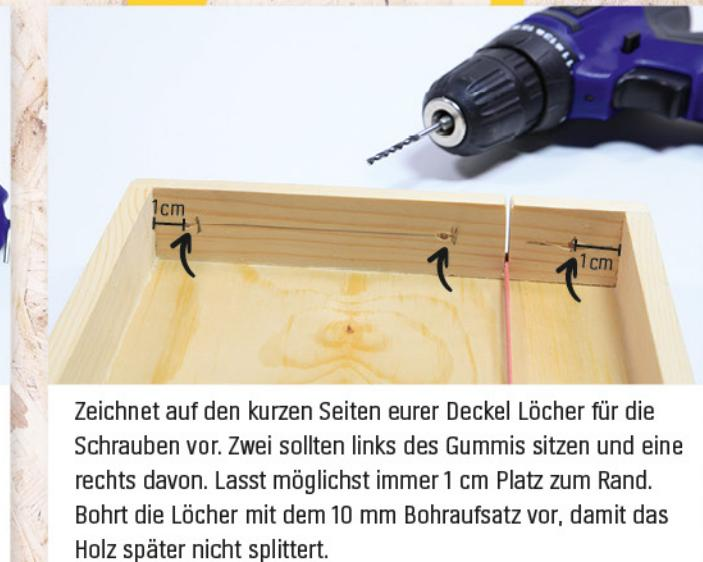
Zeichnet auf den kurzen Seiten eurer Deckel Löcher für die Schrauben vor. Zwei sollten links des Gummis sitzen und eine rechts davon. Lasst möglichst immer 1 cm Platz zum Rand. Bohrt die Löcher mit dem 10 mm Bohraufsatz vor, damit das Holz später nicht splittert.
