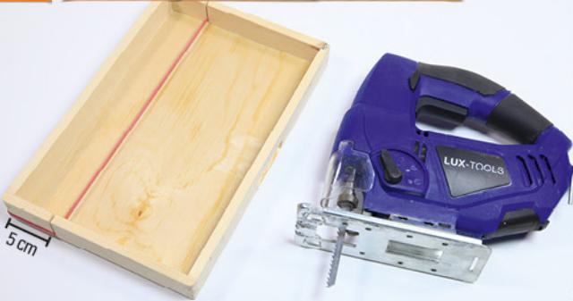
Messt auf der kurzen Seite eurer Deckel 5 cm vom Rand ab (**geht von der Seite ohne Öffnung aus**). An dieser Markierung sägt ihr mit der Stichsäge einen Schlitz in das Holz. Lasst etwa 0,5 cm Abstand zum Boden. In die seitlichen Schlitze spannt ihr die Gummis ein.
