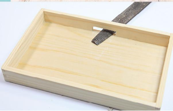
Mit der Feile glättet ihr die unteren Seiten eurer frisch gesägten Öffnungen. Sie sollte genau mit dem Rest der beiden Deckel abschließen.
