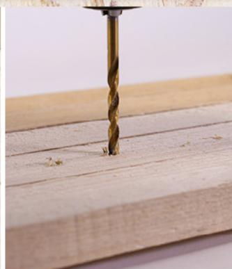
Nehmt den 6-mm-Bohraufsatz und bohrt eure Löcher dort, wo die Filzstift-Abdrücke zu sehen sind. Bohrt dabei komplett durch die Latten hindurch.
