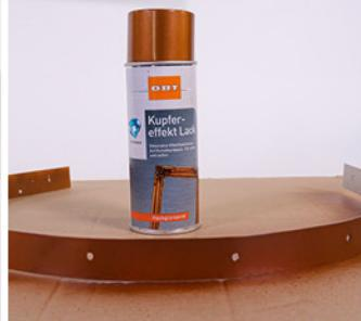
Vor dem Lackieren muss das Aluminium zunächst gut angeschliffen werden. Denn Aluminium hat eine Oxidschicht, die sonst dafür sorgen würde, dass eure Farbe nicht gut haftet! Nach dem Schleifen könnt ihr die Aluleiste mit eurem Lack besprühen. Anschließend heißt es: Trocknen lassen.
