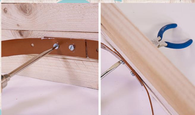
Jetzt verschraubt ihr den Ring mit dem Brett. Nehmt dann die zu den metrischen Schrauben gehörenden Muttern. Die Muttern könnt ihr auf der Rückseite mit einer Zange festhalten, während von vorne die Schrauben reingedreht werden. Das geht am besten zu zweit!
