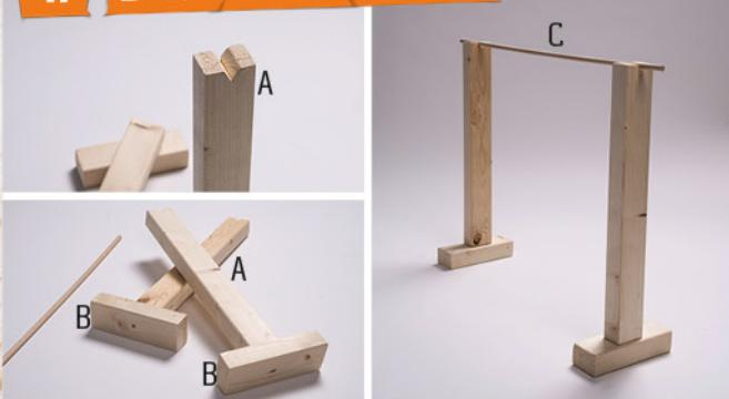
Bohrt mit der Bohrmaschine eine Kerbe in ein Ende der Holzlatte (A) und schraubt das andere Ende mittig an einem Holzstück (B) fest – macht das insgesamt 2 Mal. Jetzt stellt beide Seiten auf und legt den Holzstab (C) als Balken obendrauf.
