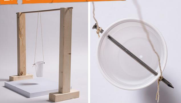
Bohrt als erstes ein Loch in den Boden des Bechers. Dann durchsteckt ihn oben mit einem Nagel und hängt ihn mithilfe einer Kordel am Balken auf – fertig ist euer Pendel. Wichtig: Achtet im Umgang mit dem Nagel auf euch und andere und passt immer auf, dass sich niemand verletzt.
