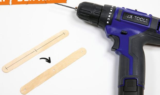
Zeichnet bei 10 eurer 15 Mundspatel die Mitte ein. Markiert auch an den beiden Enden eurer Spatel Punkte. Achtet darauf, dass die Markierungen auf allen Holzstücken identisch sind. Bohrt jetzt in jedes der 10 Hölzer drei Löcher mit dem 2 mm Bohraufsatzt.
