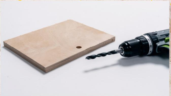
Jetzt folgt nur noch der Boden, der aus der letzten Multiplexplatte besteht. In diese bohrt ihr nur noch ein Loch, durch das nachher ein Ladekabel geführt werden kann. Benutzt dafür den 10 mm Bohrer.
