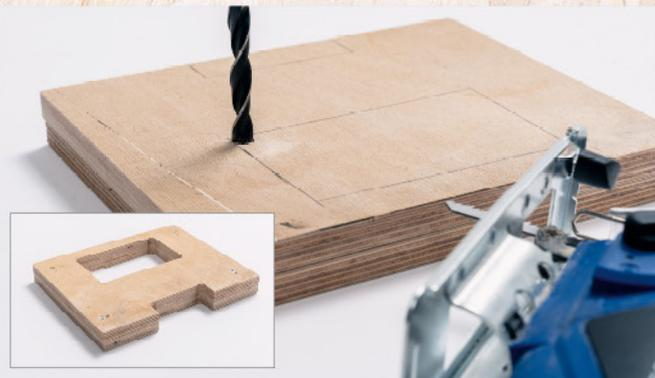
Nehmt nun den verschraubten Block, bohrt an die Ecken des eingezeichneten Ablagefachs jeweils ein Loch mit dem 10 mm Bohrer und sägt mit der Stichsäge von Ecke zu Ecke. Sägt außerdem das eingezeichnete Handyfach aus. Danach schleift die Ecken mit Schleifpapier ab.
