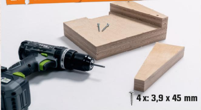
Bringt jetzt die beiden Keile mit jeweils zwei Schrauben (3,9 x 45 mm) und etwas Leim am Zwischenboden der Handybox an.
