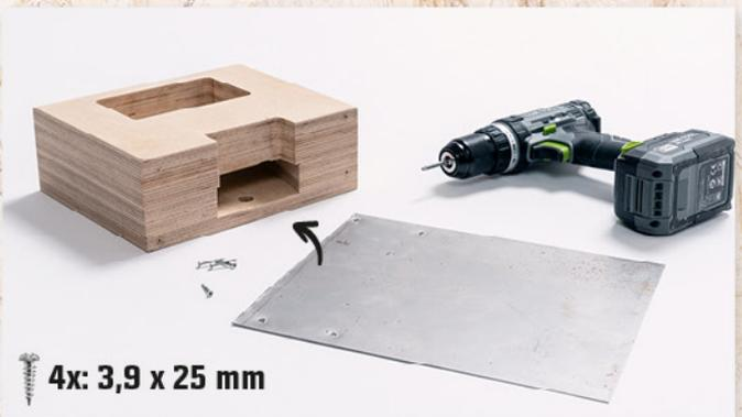
Jetzt fehlt nur noch die Metallplatte. Schraubt sie senkrecht an der Rückseite fest. Bohrt die Löcher zunächst mit dem 3 mm Bohrer vor und schraubt dann die vier 3,9 x 25 mm Schrauben hinein.
