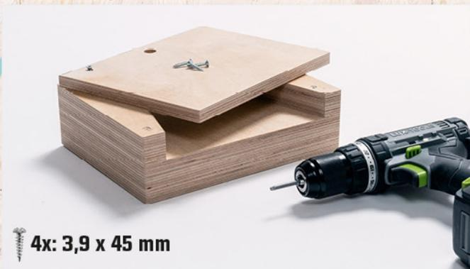
Verleimt und verschraubt die Bodenplatte mit dem Handyfach. Nutzt dafür die übrigen 3,9 x 45 mm Schrauben.
