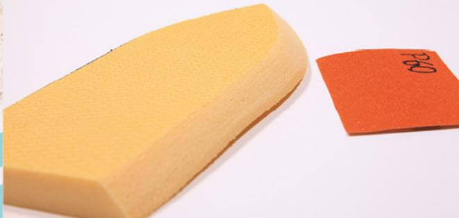
Schleift nun die Ränder leicht schräg nach mit dem Schleifpapier ab.
