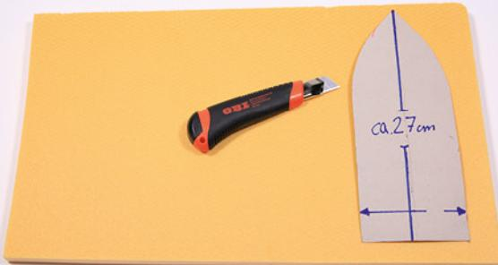
Zeichnet mit dem Bleistift eine 27 cm lange Schiffsform auf die Pappe und schneidet sie aus. Dies wird eure Schablone. Legt diese auf die Styrodur-Platte und malt ringsherum die Schneidekontur. Nehmt nun den Cutter und schneidet vorsichtig entlang der Konturlinie, bis ihr die Form leicht herausdrücken könnt.
