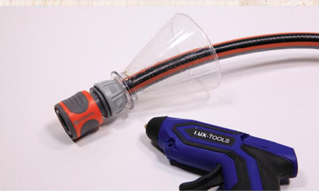
Schraubt die bisher unpräparierte Seite (also die ohne Ventil) eures Schlauchs auf und zieht sie durch den „Flaschenkragen“ durch. Klebt den Flaschenhals dann mit Heißkleber am Verschluss fest.
