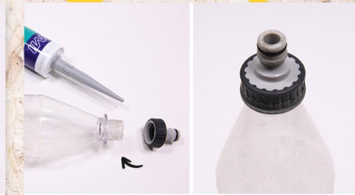
Gebt jetzt etwas Silikon in den Schlauchanschluss und steckt ihn dann auf die Flasche mit dem abgeschmigelten Gewinde.
