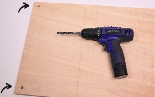
Bohrt in zwei Ecken eurer Holzplatte Löcher mit dem 8 mm Bohrer. Hier können später große Nägel oder Schrauben durchgesteckt werden, die sich in den Boden bohren, um der Konstruktion zum Beispiel auf einer Wiese guten Stand zu bieten.
