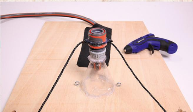
Zieht den Knoten der Schnur fest um den Schlauchverschluss, und fixiert das Ganze mit etwas Heißkleber.
