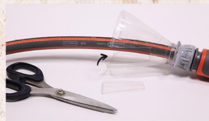
Mit der Schere schneidet ihr seitlich einen breiten Schlitz in den Flaschenkragen. Hier muss der Schlauch gut doppeln.
