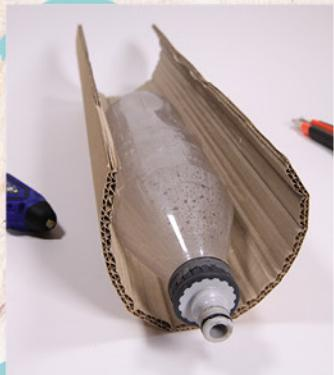
Legt die Wellpappe um die Flasche und schneidet sie passend zu, sodass sie genau einmal herum passt. Nehmt die Heißklebepistole und klebt die Pappe rund um die Flasche fest. Das Schlauchventil sollte ein Stück aus der Rolle hervorschauen.
