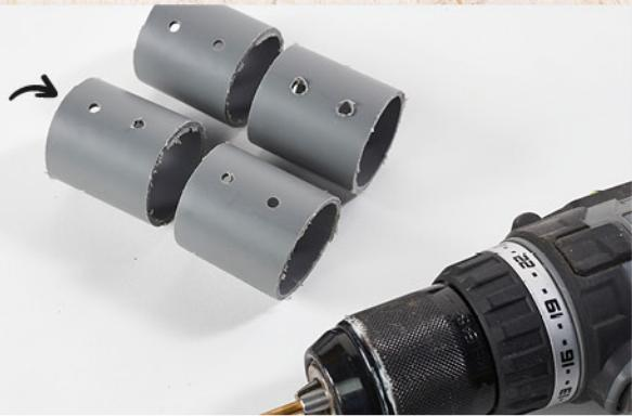
Bohrt zwei Löcher übereinander mit dem 4 mm Bohraufsatz, die nach oben und unten jeweils 1 cm vom Rand entfernt sind.
