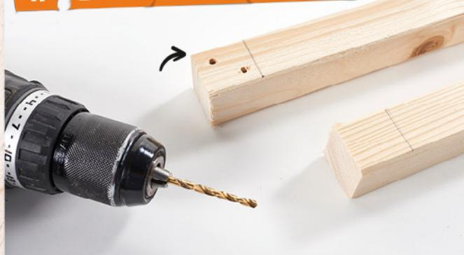
Zeichnet an den beiden längsten Kanthölzern (A) jeweils an den Enden ein 34 mm x 34 mm Quadrat an und bohrt mit dem 5 mm Bohraufsatz in jedem Quadrat zwei Löcher, wie auf dem Bild.
