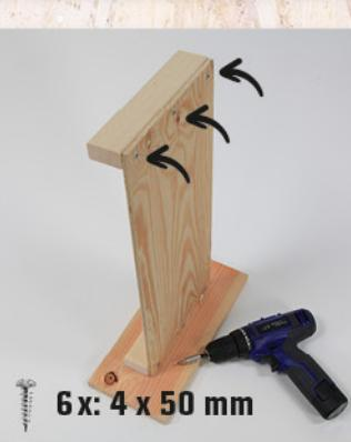
Schraubt die Sperrholzplatte unten an euer eben angebrachtes Kantholz. Befestigt das andere kurze Kantholz am oberen Ende der Sperrholzplatte. Benutzt dafür sechs der 4 x 50 mm Schrauben. Die Löcher dafür wurden im ersten Schritt vorgebohrt.
