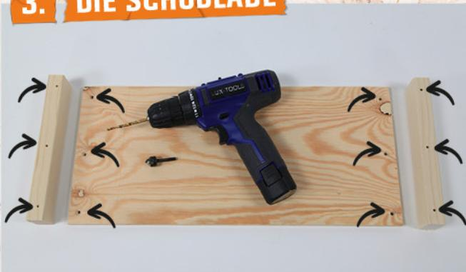
Markiert an den Seiten eurer beiden Sperrholzplatten je 3 Löcher. Eines muss mittig sitzen, die anderen beiden mit ca. 1 cm Abstand zum Rand. Diese Löcher müssen auch auf die kleinen Kanthölzer (4,4 x 2,4 x 21 cm) übertragen werden. Achtet darauf, dass die Löcher genau in der Mitte der Kanthölzer sitzen und bohrt sie vorsichtig vor. Sie sollen später genau mit der Sperrholzplatte abschließen. Verwendet wieder den Senker, um die Bohrlöcher abzuschrägen.
