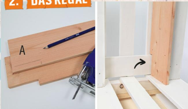
Mit der Stichsäge müssen jetzt 2 Douglasien-Bretter (A) „ausgeklinkt“ werden. Das heißt: Damit die Bretter später genau in eure obere Palette passen, braucht ihr kleine Auskerbungen an der unteren Rückseite eurer Holzbretter. Nehmt am besten direkt an der Palette Maß und sägt sie dann mit der Stichsäge vorsichtig zu.
