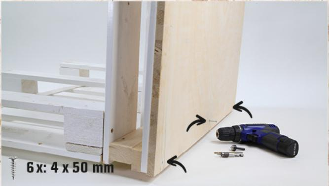
Jetzt muss die fertige Tischlerplatte außen auf die untere, noch nicht verschraubte Seite eurer Tischplatte montiert werden. Bohrt auf der Platte rechts und links je drei Löcher vor. Sie sollten gleichmäßig und symmetrisch verteilt sein. Schraubt die Platte dann mit 6 Schrauben fest.
