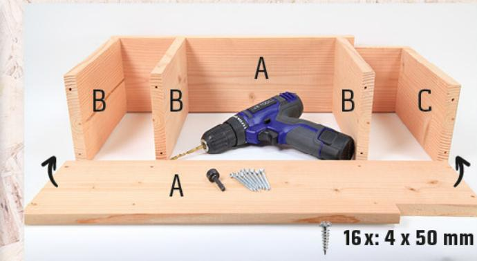
Die Bretter B und C werden eure Regalböden. Sie müssen jetzt mit den Seitenteilen A verschraubt werden. Am besten zeichnet ihr euch auf einem Brett A die Bohrlöcher auf und überträgt sie dann auf das zweite Brett A. So könnt ihr sicher sein, dass sie später symmetrisch sind.
