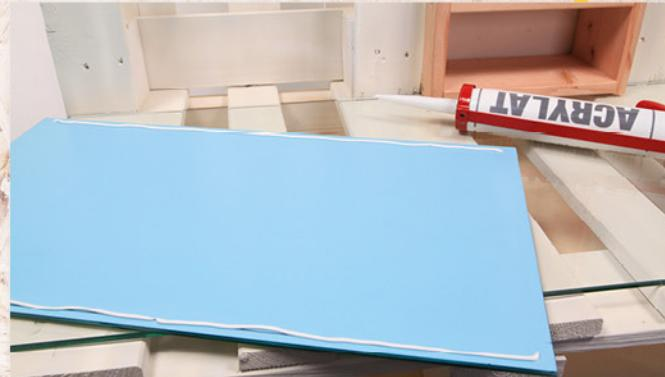
Jetzt kommt der Spiegel. Der muss mit Acryldichtstoff oder eurem Spiegelklebeband aufgeklebt werden. Verwendet ihr Acryldichtstoff, dann spannt die Tube in die Kartuschenpresse und spritzt auf beiden Seiten etwas davon auf euren Spiegel. **Tragt dabei Handschuhe!** Das Spiegelklebeband könnt ihr einfach aufkleben und die Rückseite abziehen. Setzt ihn dann vorsichtig auf die freie Seite eurer Palette, neben das Regal. **Seid vorsichtig, damit euch der Spiegel nicht zerspringt!**
