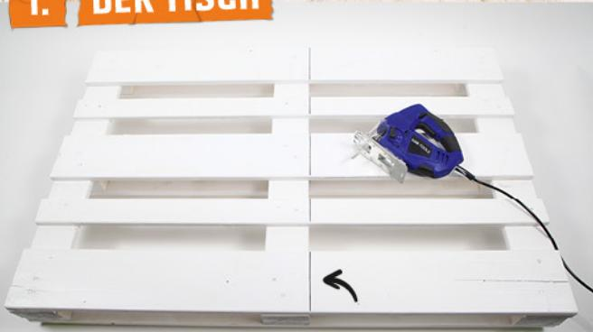
Nehmt euch den Bleistift und euren Zollstock und markiert auf der Palette die rechte Kante des Mittelbalkens auf allen Querstreben. Wiederholt das auf der Rückseite der Palette. Sägt dann mit der Stichsäge entlang der Markierung, sodass ihr zwei Palettenteile erhaltet.
