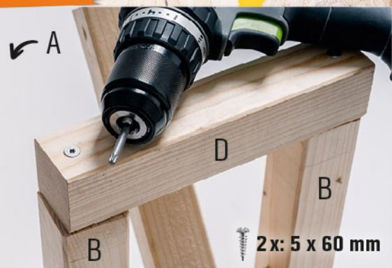
Dreht das bewegliche Teil aus Kantholz A in Richtung der beiden Querverbindungen am Fußteil. Dann nehmt ihr euch noch ein 21,5 cm Kantholz (D) und legt es als Querverbindung oben auf die Kanthölzer B auf. Schraubt das Stück dann von oben, mit je einer 5 x 60 mm Schraube pro Seite, fest.
