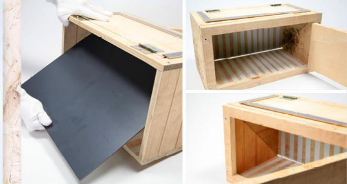
Jetzt setzt ihr den Spiegel ein. Steckt ihn von hinten schräg in den Rahmen der Oberseite. Der Spiegel sollte so passgenau im Rahmen stecken, dass eine weitere Fixierung nicht nötig ist.
