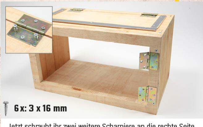
Schraubt die Holzplatten (D und E) an die Tür. Die lange Holzplatte (E) schraubt ihr an die lange Seite, die beiden kurzen Platten (D) danach an die kurzen Seiten. Die Holzplatten müssen ein paar mm über die Kante hinausstehen, damit der Deckel nicht nach unten fällt. Nutzt dazu drei 3 x 16 mm Schrauben für die lange und jeweils zwei für die kurzen Seiten.
