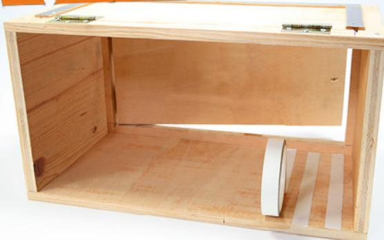
Dreht die Box mit der komplett offenen Seite zu euch. Dann nehmt ihr das weiße Klebeband und klebt im gleichmäßigen Abstand Streifen auf den Boden der Box, wie auf dem Foto.
