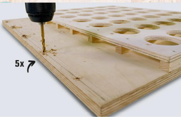
Bohrt unten auf der überstehenden Fläche in die Multiplexplatte mit dem 4-mm-Bohrer 5 Löcher in gleichmäßigen Abständen vor.
